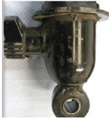
Kuva: Armstrong-vaimennin yhdellä kahteen suuntaan vaikuttavalla säädöllä
